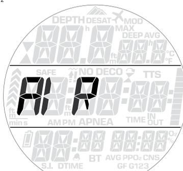
Lorsque vous choisissez **NitROX**, il vous est présenté un sous-menu qui vous permet de définir le pourcentage d'oxygène du mélange (O<sub>2</sub>%) et la valeur maximale de la pression partielle d'oxygène (ppO<sub>2</sub>max) pour jusqu'à trois mélanges respiratoires. La valeur maximale qui est possible pour la ppO<sub>2</sub>max est de 1,6 bar. La plupart des organismes de formation recommandent de ne pas dépasser une valeur de 1,4 bar.
