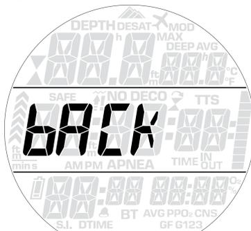
Au cours de la plongée, appuyer sur le bouton permet d'accéder à des informations supplémentaires, et une pression prolongée sur celui-ci permet d'activer le rétroéclairage.
