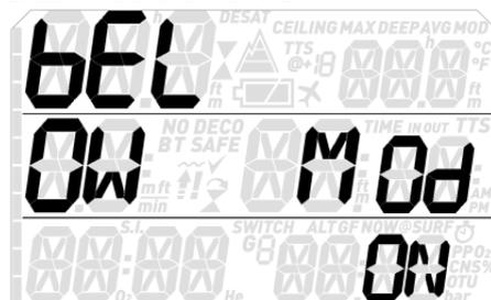
Lorsque ce paramètre est réglé sur **ON**, le Quad 2 va permettre un passage à un gaz à une profondeur plus grande que sa MOD (ce qui provoque une alarme de MOD immédiate).
