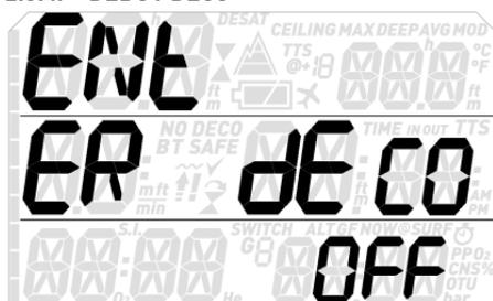
Lorsque ce réglage est positionné sur **ON**, un avertissement vous alertera lorsqu'un palier de décompression obligatoire a été calculé par le Quad 2.
