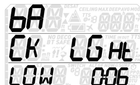
Ce menu vous permet de régler la durée du rétroéclairage, entre 2 et 12 secondes. Le réglage par défaut est 6 secondes.
