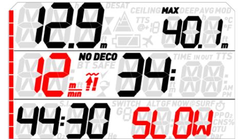
Cela persiste jusqu'à ce que la vitesse de remontée passe sous la vitesse limite déterminée. Les limites dépendent de la profondeur actuelle, comme suit :
