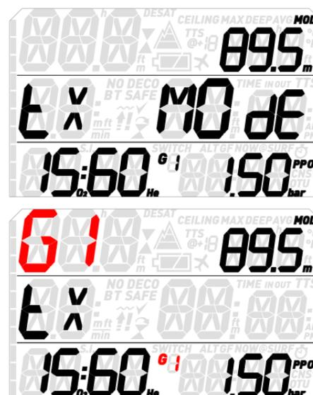
Le Quad 2 vous permet de paramétrer jusqu'à 5 mélanges gazeux, pour lesquels en plus du pourcentage d'oxygène vous pouvez aussi régler le pourcentage d'hélium. Tout le reste est identique à l'affichage multigaz pour le Nitrox, avec en plus les OTU (unités de toxicité de l'oxygène) dans la séquence de données qui s'affichent dans le coin en bas à droite.
