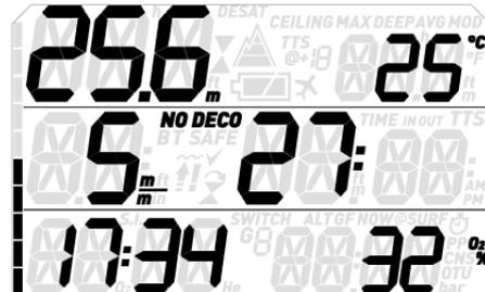
Dès que la profondeur diminue, le Quad 2 active le contrôle de la vitesse de remontée, et affiche la valeur calculée sous forme graphique et numérique.
