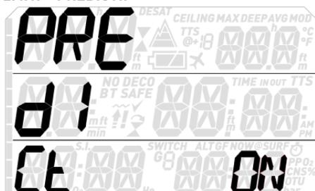
Lorsque ce paramètre est réglé sur **ON**, le Quad 2 prend en compte tous les gaz pour les calculs de décompression, avec les passages effectués à la MOD de chacun des gaz. Lorsqu'il est sur **OFF**, les calculs de décompression ne prennent en compte que le gaz qui est actuellement utilisé. Consultez la Section 10 pour plus d'informations sur la fonction **PRÉDICTIF**.
