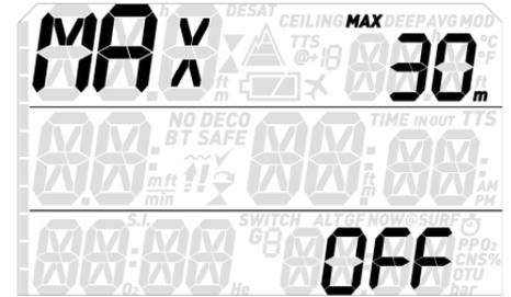
Le Quad 2 vous permet de régler une alarme à une profondeur indépendante de la MOD. La valeur par défaut est **OFF**. Par des pressions courtes **TR-SP** ou **BR-SP** vous pouvez la régler entre 10 m et juste au-dessous de la MOD, par incréments de 1 m. Lorsque la profondeur définie est atteinte, une alarme de comportement similaire à celle de la **MOD** (section 7.3.2) se déclenche.
