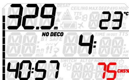
Si la toxicité de l'oxygène atteint 75 %, remontez à une profondeur moins importante afin de diminuer la charge en oxygène, et mettez fin à la plongée.
