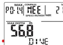
Une nouvelle pression simultanée sur les deux touches permet d'afficher la boussole en degrés (nombres ordinaux) 0°-359°.
