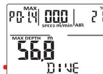
La vitesse verticale peut être affichée en m/min ou FT/min selon le réglage métrique/impérial. Pour activer la boussole, appuyez simultanément sur les boutons la boussole s'affichera à la place de la vitesse verticale en indiquant les points cardinaux comme sur la figure :
