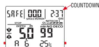
L'arrêt est indiqué sur l'écran par l'icône SAFE ; l'écran, dans cette condition, indique clairement la durée en minutes et en secondes avec un compte à rebours. L'arrêt de sécurité n'est pas obligatoire mais il est fortement recommandé si, par exemple, la vitesse maximale de montée est dépassée de façon répétée. Cressi recommande de le respecter à tout moment afin de ne pas rencontrer de problèmes de sécurité.
