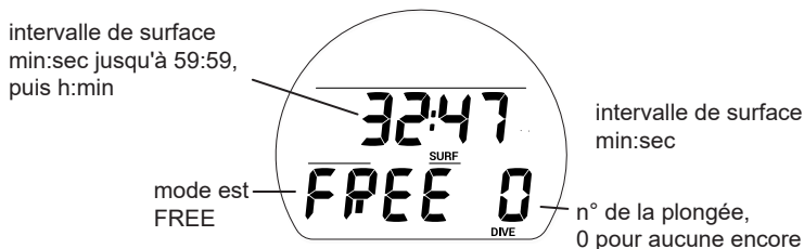
ÉCRAN PRINCIPAL MODE SURFACE FREE (pas encore de plongée ou intervalle de surface SI > 1 min)
